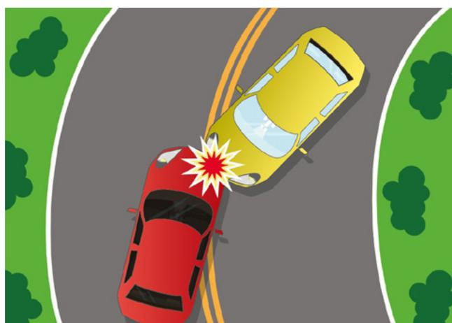
**Força centrífuga:** o veículo é jogado para fora, pois, a frente do veículo se desprende do chão. Ela está relacionada com o **comportamento subester ante** dos veículos.
