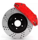
Funciona quando uma pressão hidráulica provoca o atrito das pastilhas de freio com as duas faces do disco metálico fazendo com que ele pare de girar.
