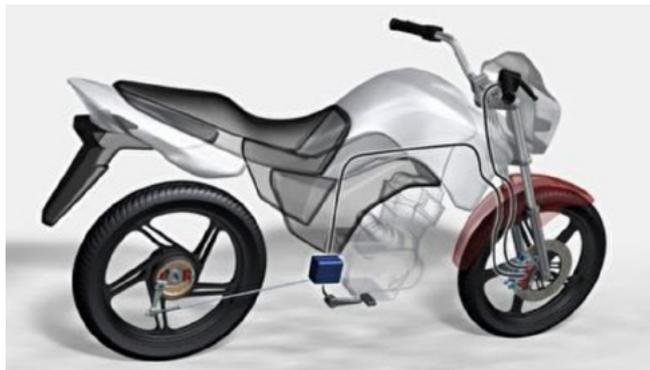
Sistema de frenagem combinada das rodas (**CBS**): sistema que distribui proporcionalmente a força de frenagem para as rodas garantindo uma desaceleração rápida e segura, independente dos sistemas serem dotados de disco ou tambor.
