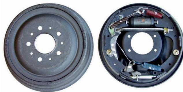
Quando acionado pelo motorista, uma pressão é transmitida pelo fluido de freio até o cilindro que contém os pistões, então, eles empurram as sapatas, em direção oposta, contra a superfície interna do tambor, que gira em conjunto com a roda do carro.
